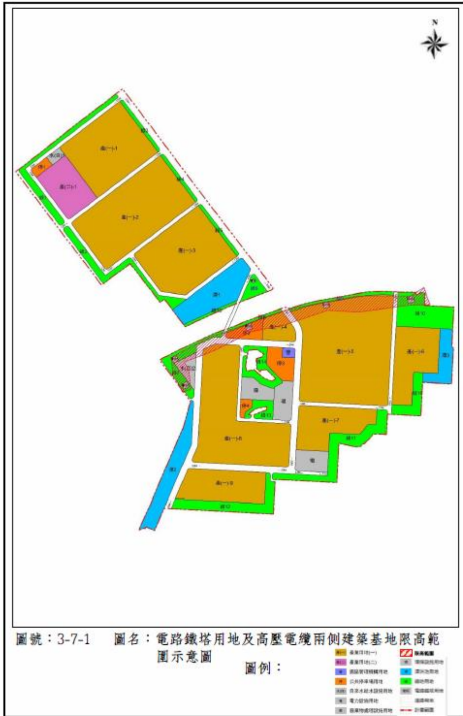
圖3 電路鐵塔用地及高壓電纜兩側建築基地限高範圍示意圖
